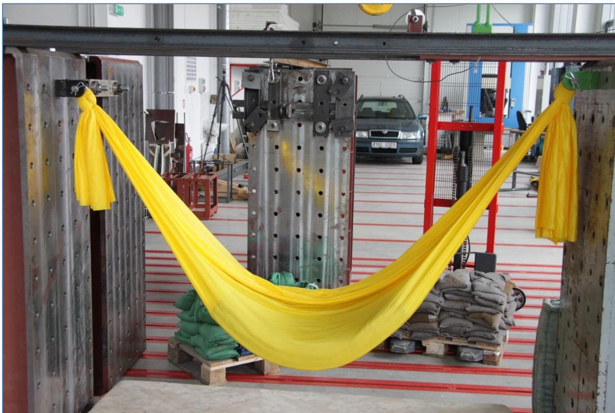
Obrázek 1 – uchycení sítě na jógu v průběhu zatěžování
